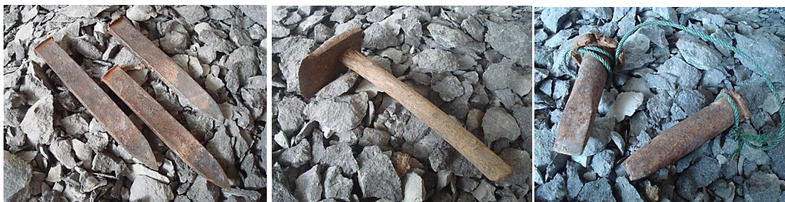
ภาพที่ 3.73 เหล็กสกัดแบบหัวแหลม เหล็กแบบหัวแบน และเหล็กสกัดแบบหัวตัด
